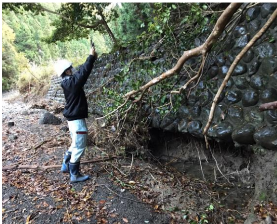
職員によるタブレット端末での点群計測 (計測時間:5~10分程度)
